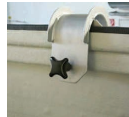
Fig. 82 Edge protection in use
