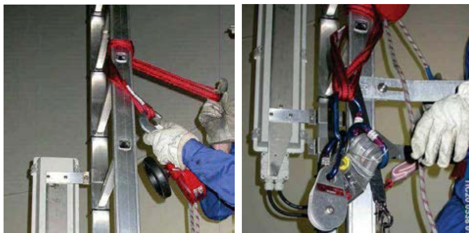
Accrocher le dispositif de descente aux barreaux de l'échelle.
